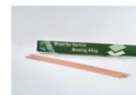
Le leghe brasanti contenenti Fosforo possono essere generalmente utilizzate per temperature di esercizio dai -70°C ai +150°C. Le leghe sono state sviluppate appositamente per giunzioni di Rame con Rame, o Rame con sue leghe (ottone, bronzo). Quando si brasa Rame con Rame, non è necessario utilizzare disossidante, dato il contenuto di Fosforo nella lega. Nel caso di brasature Rame con Leghe di Rame è necessario l'utilizzo del disossidante.
